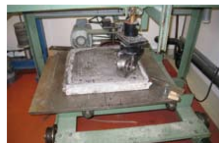
Figur 1. Provning med rullande hjul (Bring metoden) på en pågjutning på en av de stora plattorna.
