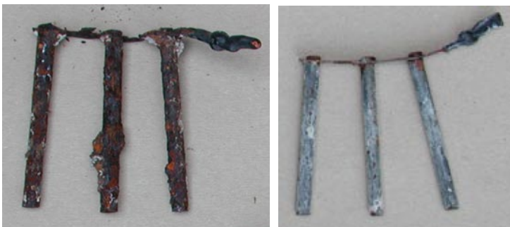
Figur 2. Skyddade med sprutad zink på betongytan och oskyddade armeringsstänger från Ölandsbron där 95 % reducerad korrosion noterats.
