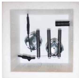
Figur 3. Laboratorieprover där inverkan av fukt, betongkvalitet och klorid-nivå undersöks. RF mäts både vid armeringen och ytan.
