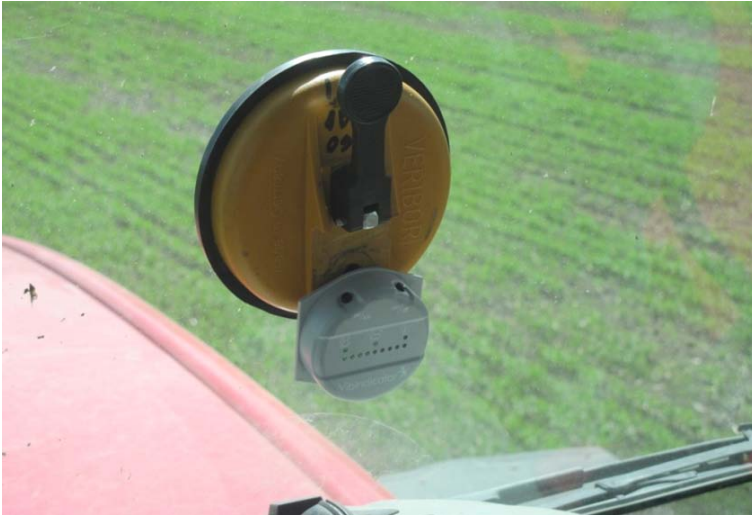
Figur 3. Bild på vibrationsindikatorn monterad på sugkopp ovanför instrumentpanelen.
