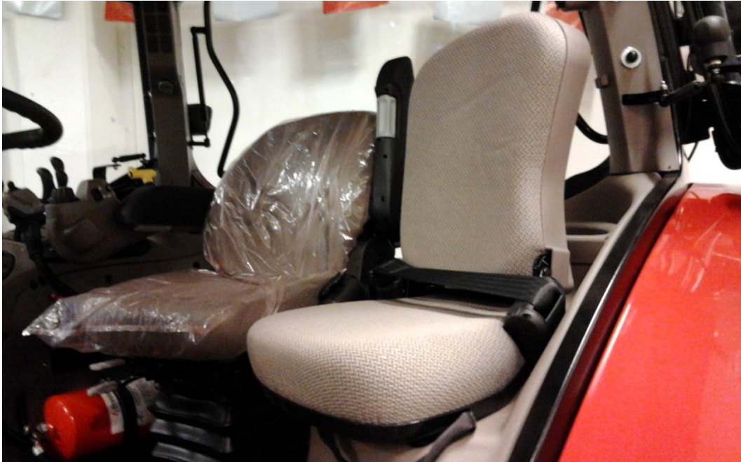
Figur 1. Exempel på passagerarstol med bälte i en ny traktor med 110 hk.
