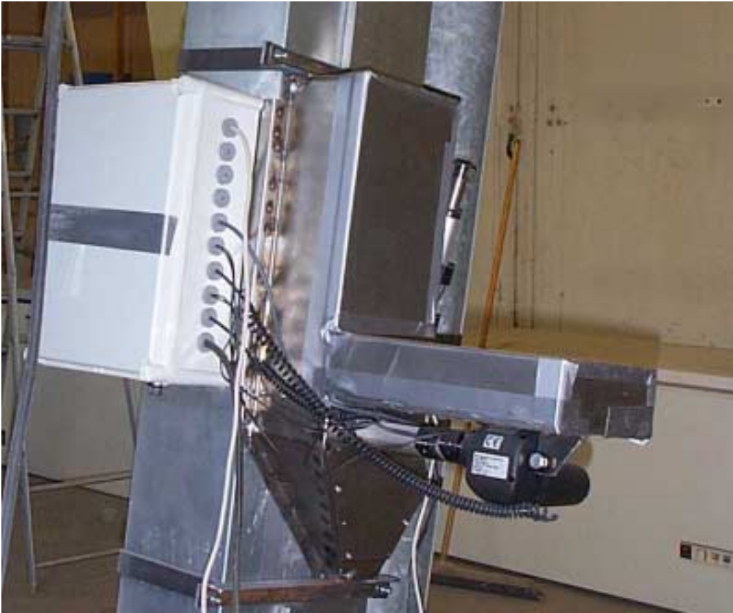
Bild 4. Provtagningsystemet med proteinsensorn monterad i provtagaren. Elmotorerna för att öppna och stänga in- och utsläppsluckorna är placerade utvändigt. PLC och spänningsregulator monterades på sidan av elevatorm. Handdator, ej i bild, användes för att lagra data.
