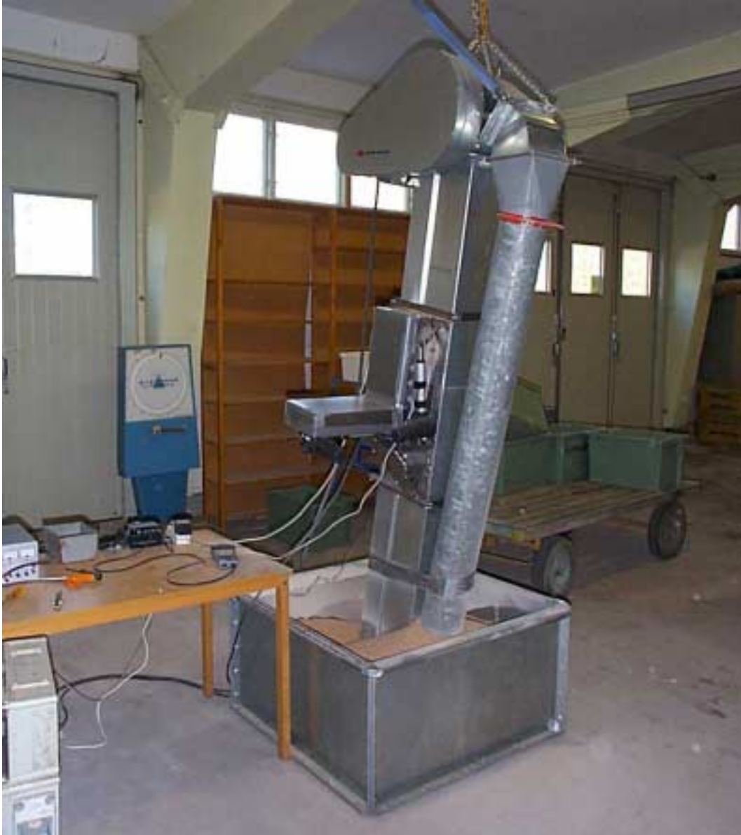
Bild 3. Sensor och provtagare monterade på en kedjeelevator i ett slutet system för spannmålstransport. Spannmålen lyfts med elevatoren och återförs med störtröret tillbaka i behållaren.
