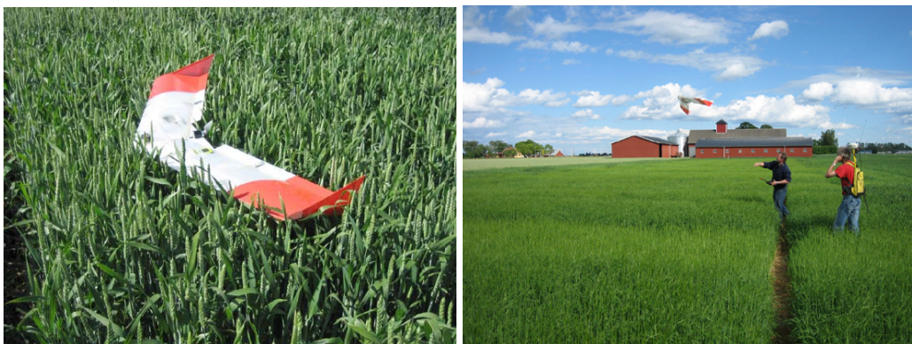
Figur 1. Smart One UAV utrustad med GPS och digitalkamera.
