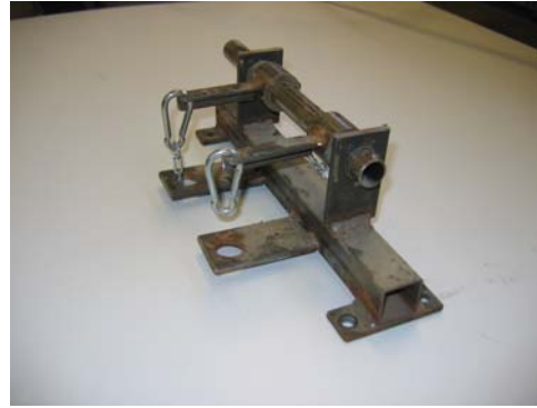
Bild 7 & 8. Vidareutveckling av repets infästning i låsanordning. Fällbygel som kan låsa upp flera båsplatser på en gång. Denna monteras på bekväm arbetshöjd på lämplig stolpe i anslutning till båsplatserna.
