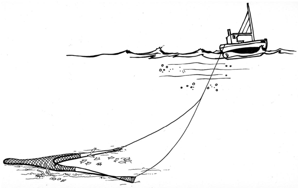
Fig. 3b) Conventional trawl
