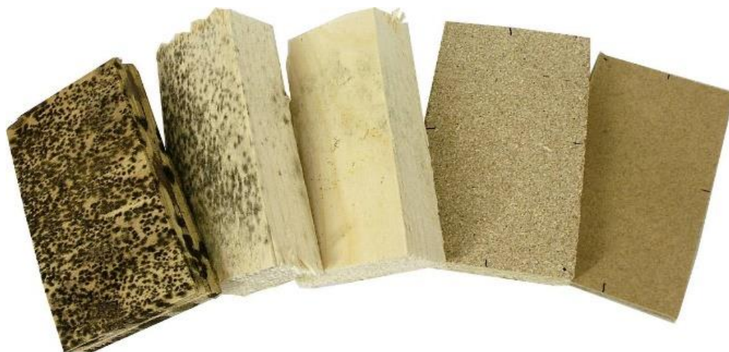
Figur 2 Prover från ett laboratorieförsök [8]. På alla prover finns omfattande påväxt, utbredningen på proverna är desamma. Ändå är missfärgningen olika.
