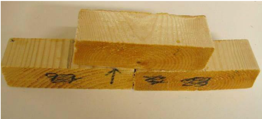
Figur 3 Provkroppars placering i [27]. Pilen pekar på den yta som analyserats för att studera effekten av fördröjd uttorkning.
