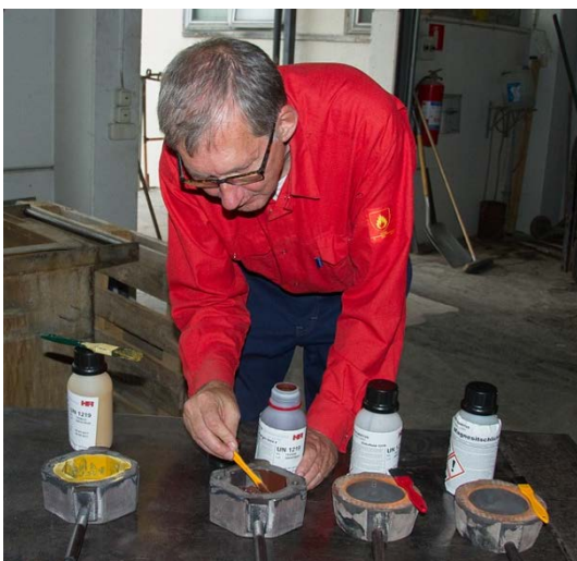
Figur 5. Applicering av blacker i gjutjärnsformar på Målerås glasbruk
