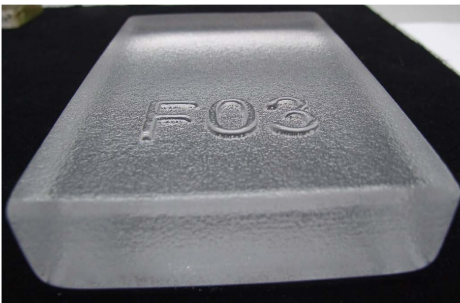
Figur 11. Märkning av sandform som ger avtryck i glaset
