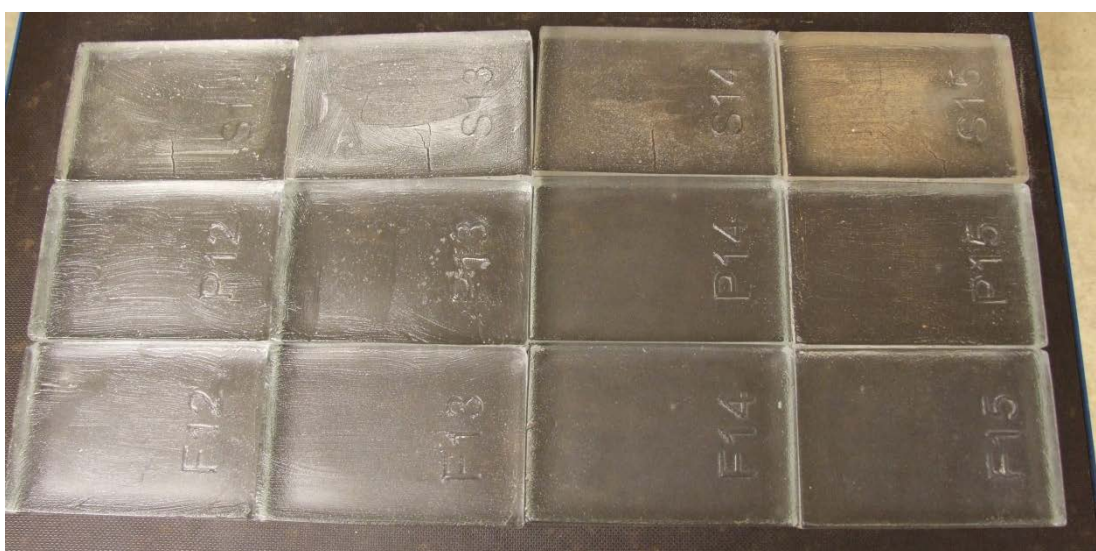
Figur 13. Glasblock gjutna i 3D-printade sandformar med olika bindemedel och blacker
