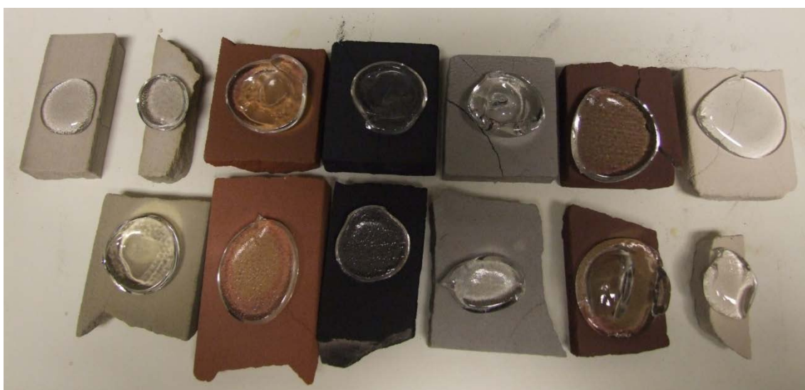
Figur 18. Sandformsbitar sprutbelagda med blacker i tunn och mättad grad. Den översta raden tunn beläggning och den nedersta raden mättad beläggning. Från vänster referens utan beläggning, magnesit 5848, koalid 4087, nekrofluid 1305, koalid 2290, akrofluid 5004F och zirkonfluid 1219.
