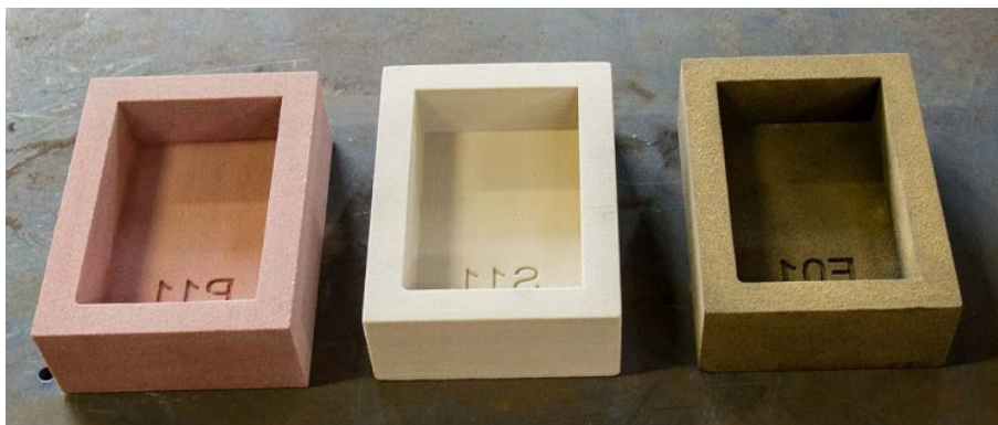
Figur 2. Sandformar med bindemedel fenol (P), vattenglas (S) och furan (F)
