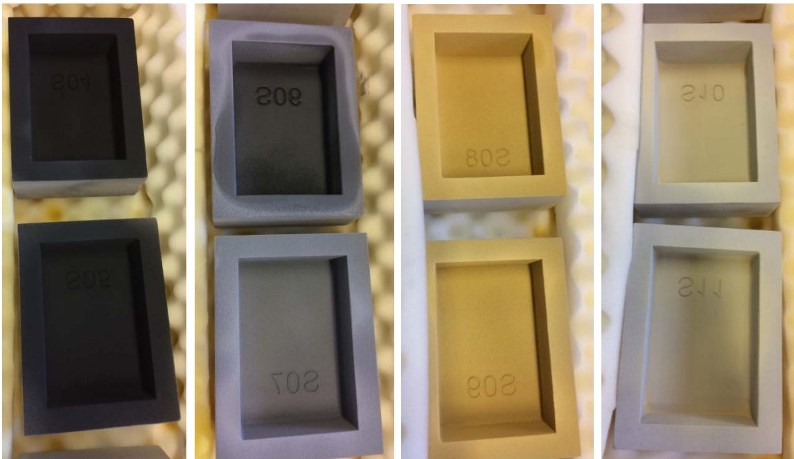
Figur 4. Sandformar S05-S11 sprutbelagda med blacker
