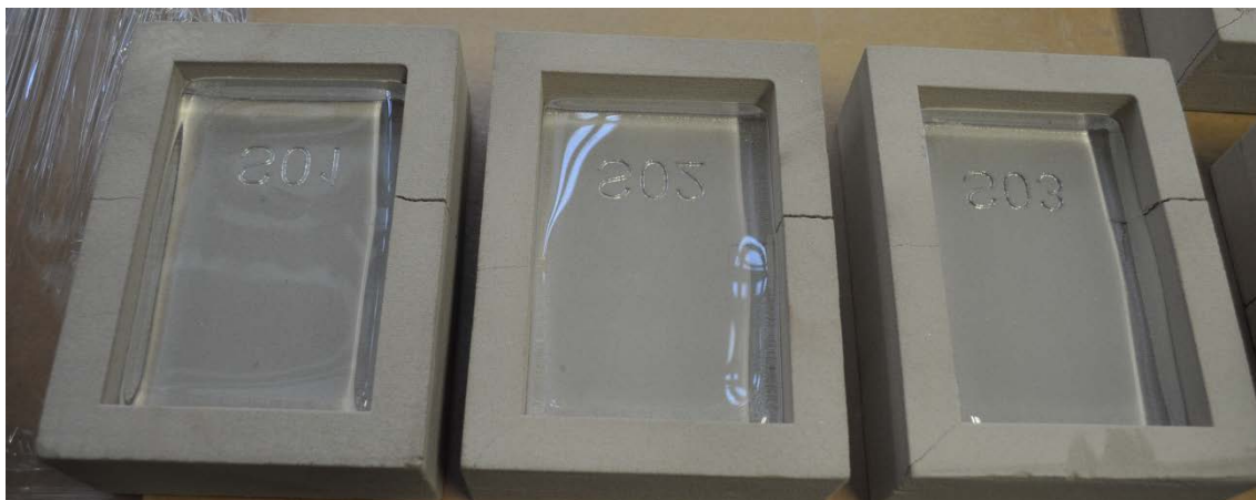
Figur 12. Spruckna sandformar innehållande bindemedlet vattenglas
