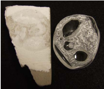
Figur 17. Sandform belagd med litiumkarbonat och glasprov
