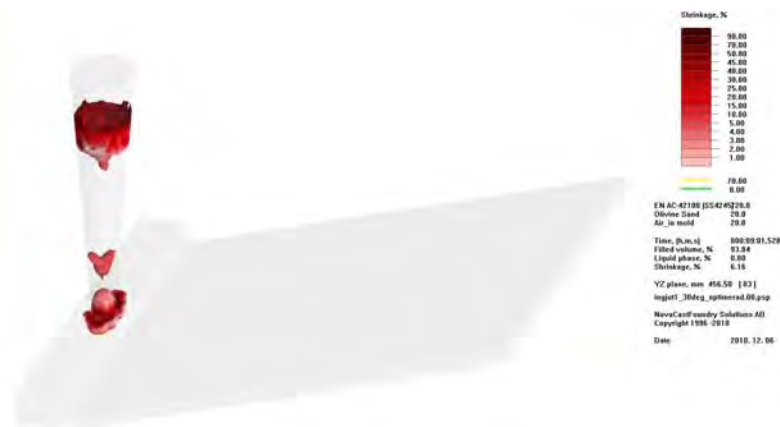
Figur 13: Porfritt på grund av det riktade stelnandet.
