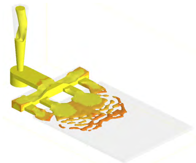
Figur 6: Fragmenterad smältfront med stor risk för filmbildning, inneslutningar och kallflytningar/kallveck.
