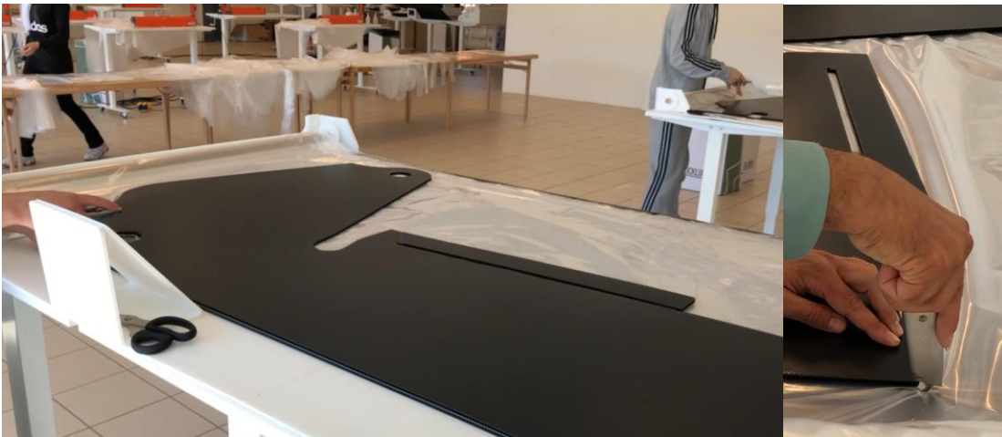
Bild: Skärmall för manuell tillskärning av långärmade skyddsförkläden. Säkerhetskniv används för säkrare operation.
