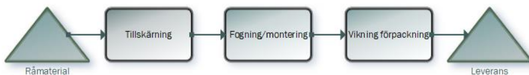
Figur: Generell produktionsprocess för skyddsförkläden/visir
