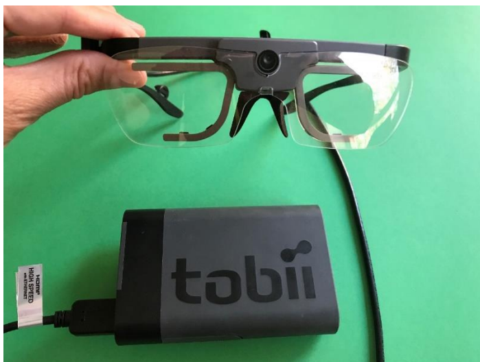
Bild 1. Eyetracking-glasögonen som användes i projektet, Tobii Glasses 2.
