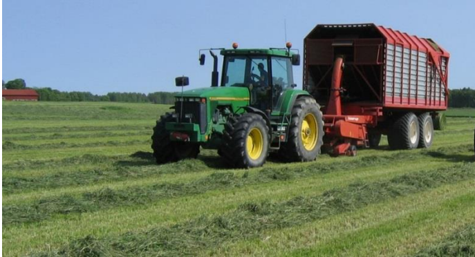
Figur 1. Hackvagn för uppsamling av gräs efter att slåtter gjort i ett separat moment.
