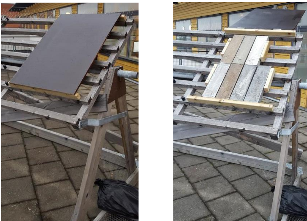
Figur 18. Fältexponering av betongprover vid Swerea KIMABs provningsstation i Kista där betongprover med olika bindemedel och ingjutna provstänger exponerades under ett regnskydd.
