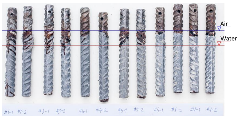
Figur 16. Provstängernas utseende efter mätningar med den galvanostatiska mätmetoden.
