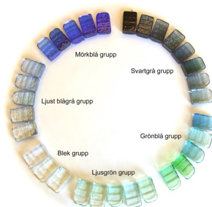
Fig2. Bild från rapporten Glafo P4452 "Återvinning av skärv –från avfall till resurs" (2008) Färgprover som visar resultatet av försök med smältning av färgsorterad skärv. Försöken resulterade i prover som kunde delas in i sex färggrupper. Försöken genomfördes vid Orrefors vanna under nio veckor 2006/2007. Foto Elisabeth Flygt/Glafo.
