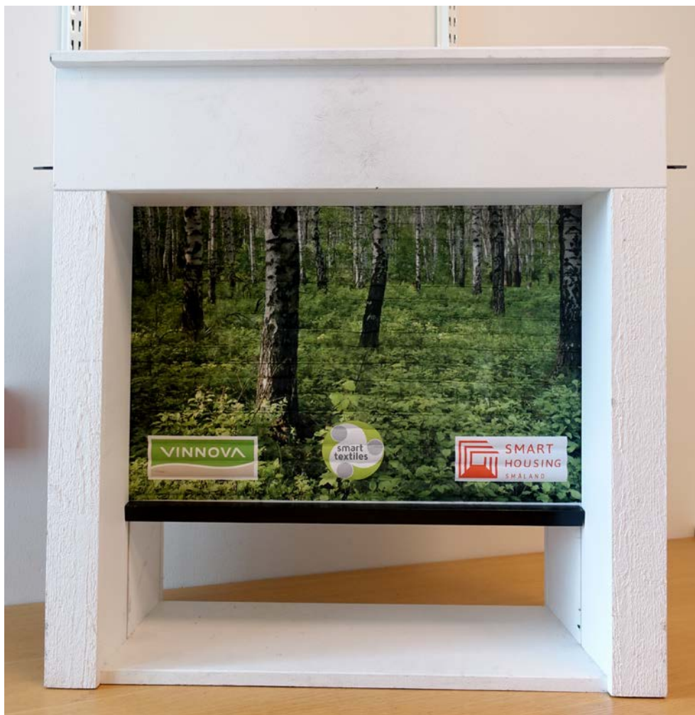
Figur 9. Prototyp i trä och textil framtagna tillsammans med Smart Textiles. Syftet är att visa hur en bostadsmodul kan delas av med en ridåvägg.
