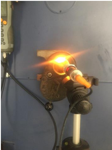
Figur 4. IR-mätare genom ett tithål.
