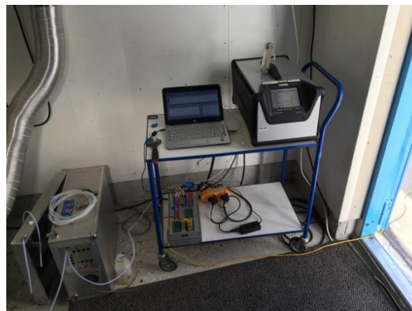
Figur 8. Provtagning \text{NO}_x , \text{CO} , \text{CO}_2 , och \text{O}_2 .
