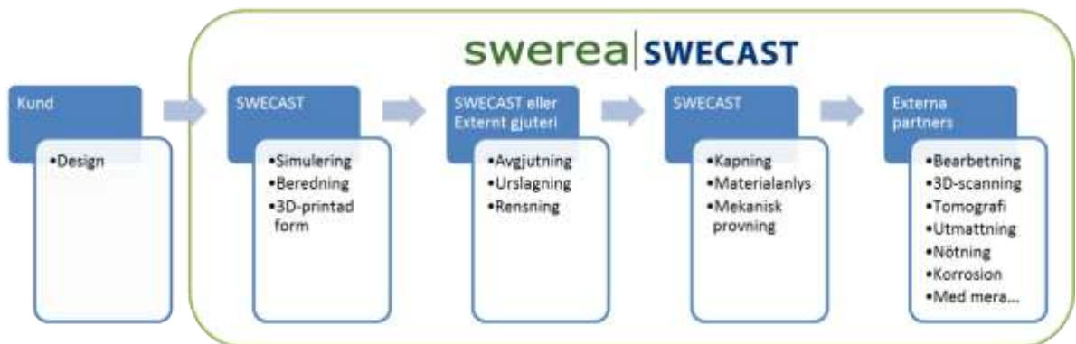
Figur 3.6. Fullt utbyggt arbetssätt för prototypframtagning med flexibla T&D-moduler. SWECAST erbjuder hela kedjan från simulering till utvärderad produkt.
