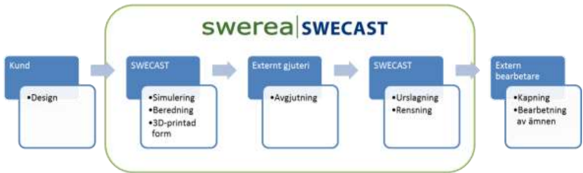
Figur 3.5. Anpassad prototypframtagning med flexibla T&D-moduler. SWECAST kontrollerar hela kedjan från simulering till rensat gjutgods, men lejer ut avgjutning då så är fördelaktigt.
