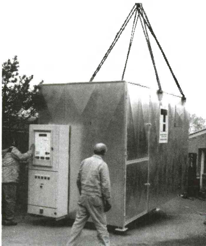
Figur 8. CATOX. Anläggningen är en katalytisk förbränning. Figuren visar en anläggning dimensionerad för 5.000 \text{ Nm}^3/\text{h} .
