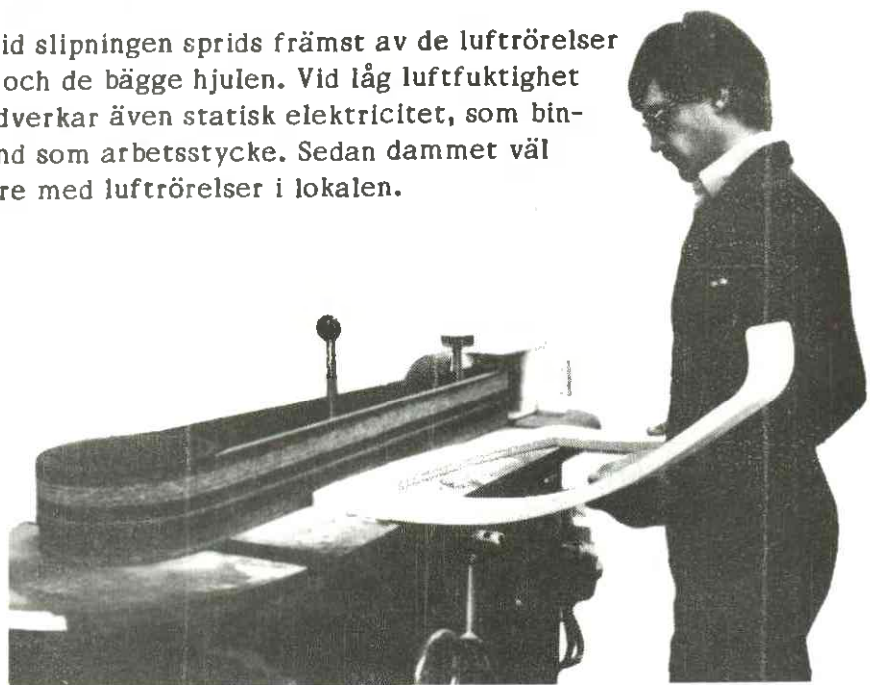
Fig 4. Slipning i vertikalkantslipmaskin. Plana eller konvexa ytor slipas mot tryckplattan utefter slipbandets långsida, med eller utan stöd av anhållet. Se även bilderna på nästa sida.
