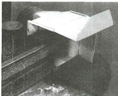
Fig 19,20. Den ställbara delen på det fasta utsugningsdonets ovansida kan vändas för att ge bästa effekt vid den aktuella slipningen.
