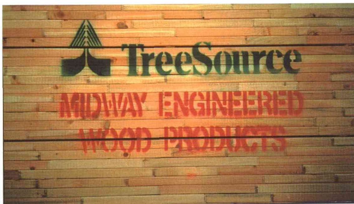
Figur 4. Fingerskarvade och hyvlade väggreglar.
