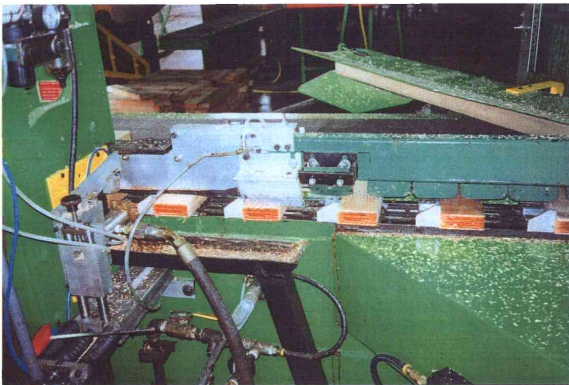
Figur 3. Detalj av skarvlinjen med frästa och limförsedda skarvämnen. Matning sker från vänster till höger.
