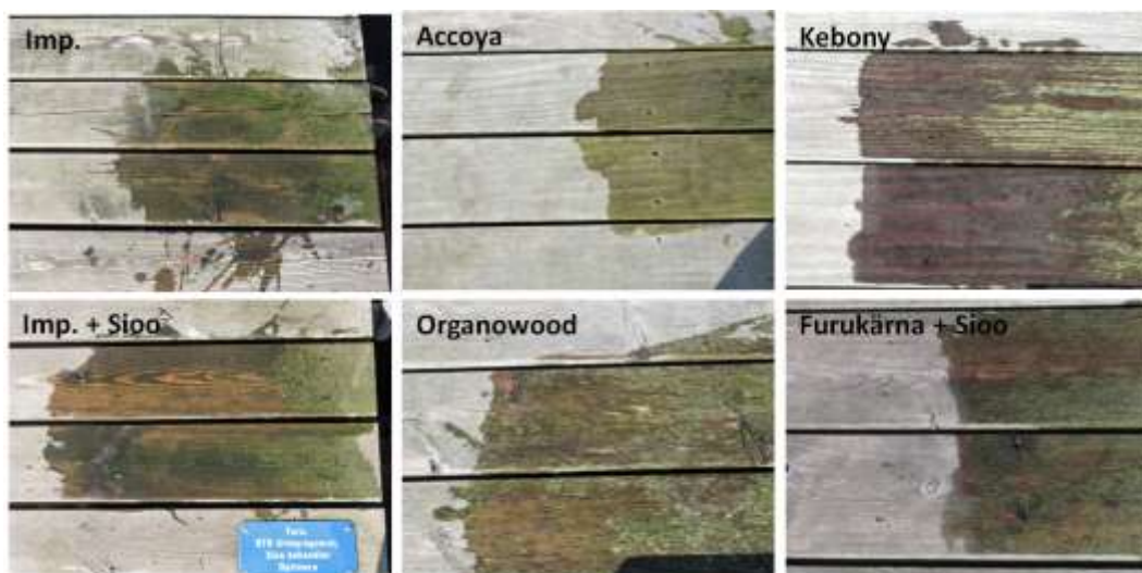
Figur 30. Illustration av algpåväxt på impregnerat och modifierat trä samt furukärna.
